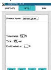
Mettez en place des protocoles de température constante pour incuber des échantillons à 0-99°C à l'aide d'une interface simple et intuitive.
