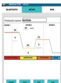
L'interface graphique de programmation de la PCR permet aux élèves d'entrer le temps et les températures directement sur le graphique d'ensemble de la PCR.
