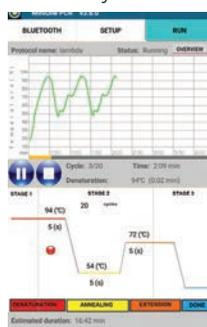
L'écran d'exécution affiche une lecture en temps réel, continuellement mise à jour, de la température, du cycle en cours, de l'étape en cours et du temps écoulé.
