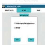
Sélectionnez le mode à température constante pour les digestions de restriction, la transformation et les extractions d'ADN, ou le mode PCR pour l'amplification de l'ADN.
