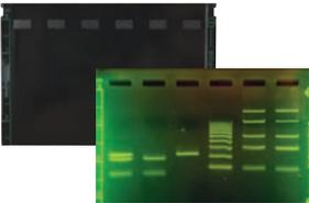
A utiliser pour la séparation de l'ADN. Plaque de plastique de couleur noire imprimée avec une règle vert fluorescent sur le bord, texture sur la zone du puits
